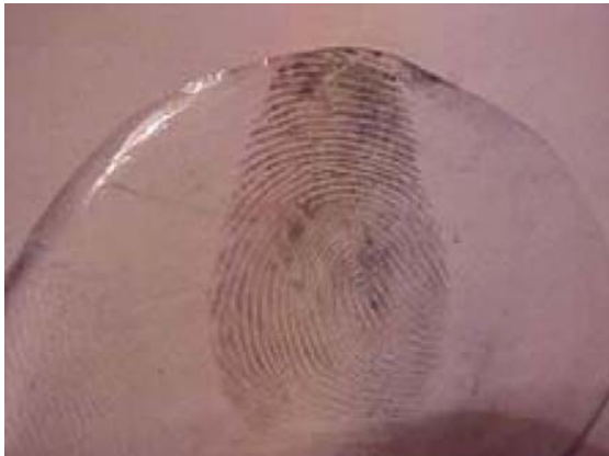
Abb. 17: Abdruck mit transp. Silikon von einem Flaschenhals
