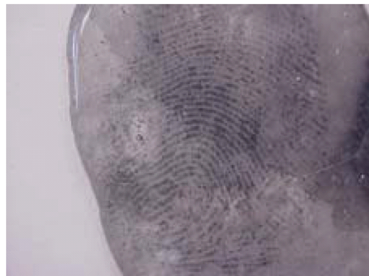
Abb. 2: transparenter Silikonabdruck vom Ziegel
